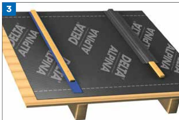
Контробрешётки (контррейки) устанавливаются в соответствии с национальными строительными правилами. Необходимо соблюдать пределы уклона, характерные для кровельного материала (РНК – рекомендованный уклон кровли).
