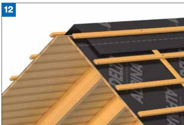
Таким образом будет обеспечено достаточное проветривание подкровельного пространства и защита от задувания снега и капель дождя. Ширина зазора должна быть подобрана в зависимости от высоты контробрезетки, угла наклона и длины покрытия.
