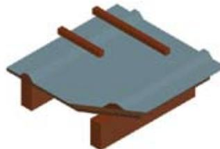
Рис. 20. Класс 1\_1.1. Традиционная конструкция с битумной гидроизоляцией и трапециевидной контробрешеткой
