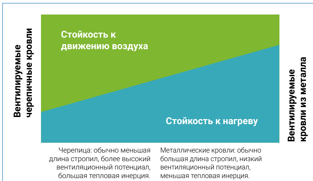
Рис. 8: Различный вес повреждающих факторов – движения воздуха и нагрева – на крышах из черепицы и металлических покрытиях.
