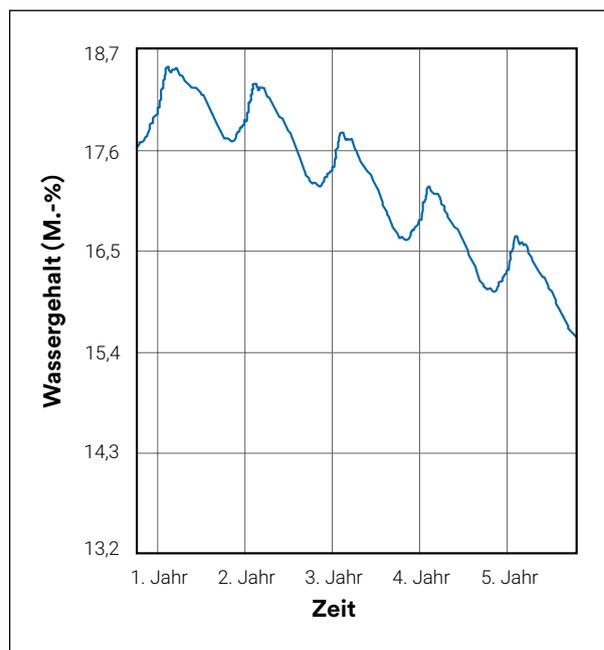
Das Ergebnis einer Simulation lässt sich z. B. in Form von Diagrammen darstellen. Die Abbildung zeigt die Entwicklung der Holzfeuchte im äußersten Zentimeter eines Sparrens über einen Zeitraum von fünf Jahren. Zu erkennen ist die periodische Aufweuchtung in jedem Winter. Da die Holzfeuchte zu keinem Zeitpunkt die 20%-Grenze übersteigt und die Holzfeuchte insgesamt sinkt, ist der Nachweis der feuchteteknischen Funktionsfähigkeit erbracht.
