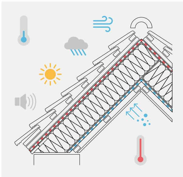
Bei der Feuchtebelastung einer Dachkonstruktion von innen ist zu berücksichtigen, dass bei Wohnnutzungen täglich mehrere Kilogramm Wasserdampf entstehen können.
