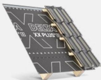
Unterdeckbahnen liegen auf einem flächigen Untergrund (Schalung, Dämmung usw.) auf. Die Überdeckung erfolgt wie bei der Unterspannung mit einem Mindestmaß von 10 cm.
