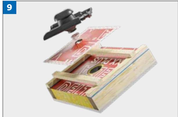
Nach der Montage des Lüfterrohrs wird der Flansch umlaufend mit DELTA-MULTI-BAND® auf die Unterdeckbahn aufgeklebt.
