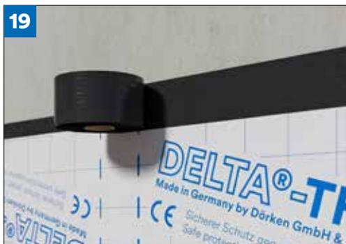
(Bild 19) Beim Einsatz von DELTA®-FLEXX-BAND sind mineralische Untergründe mit dem DELTA®-THENE GRUNDANSTRICH vorzustreichen. Möglich ist auch die Verwendung von Kappleisten oder Putzabschlusschienen, die direkt nach der Verlegung montiert werden.
