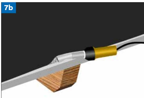
**(Bild 7b)** Alternativ können Verbundbleche mit PVC Beschichtung verwendet werden. In diesem Fall wird DELTA®-ALPINA mit dem Heißluftföhn mit der PVC Beschichtung verschweißt. Vor der Montage der Verbundbleche sollte ein Schweißversuch durchgeführt werden.
