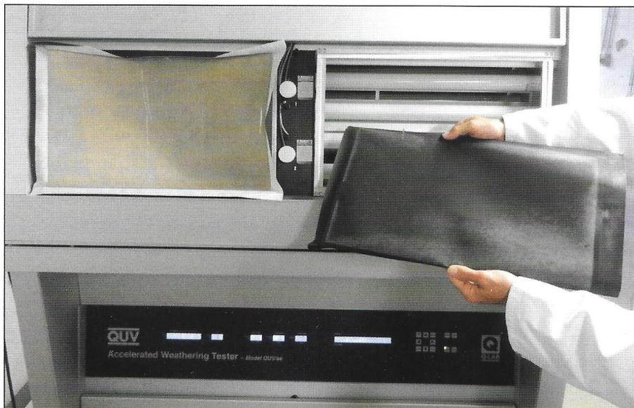
**Der kurzweilige Teil des Sonnenlichts setzt bei Kunststoffen wie Polypropylen, Polyethylen, Polyurethan und PET oder bei Bitumen eine photochemische Reaktion in Gang. Die langen Molekülketten der Vliese und Membranen, aus denen die Bahnen aufgebaut sind, werden durch die auftreffende UV-Strahlung gespalten. Auf Dauer führt dies – wie hier im Laborversuch gezeigt – zum Verspröden des Materials. Die Bahn kann dann ihre Funktion im Bereich des direkten Lichteinfalls nicht mehr erfüllen.**
