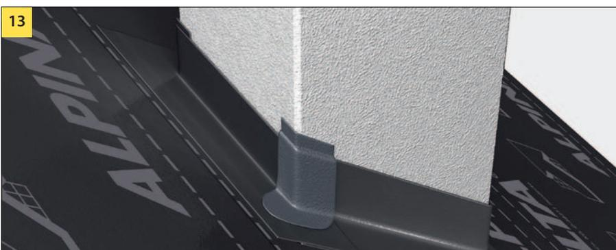
Um Anschlüsse an aufgehende Bauteile zusätzlich gegen Hinterläufigkeit zu sichern, kann DELTA®-THAN verwendet werden.
