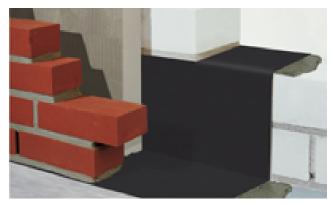
**Description:** Bande d'étanchéité souple (selon EN 14909) contre l'humidité ascensionnelle et pour l'évacuation de l'eau hors du mur creux. Raccord d'étanchéité autour des fenêtres et des tuyaux pour les constructions de façade.
