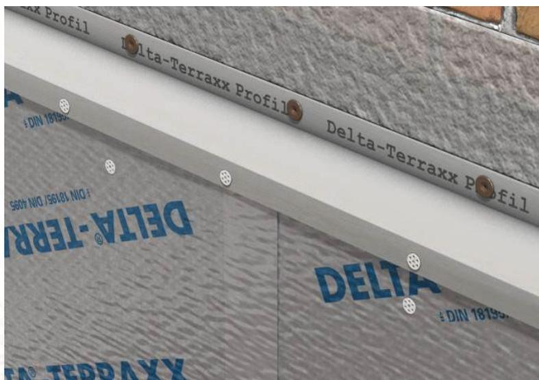
**Description:** profilé synthétique rainuré pour la réalisation de la finition en tête de parois enterrées dans le cas d'une nappe à excroissances DELTA® posée sur panneau en polystyrène extrudé (XPS). Epaisseur de panneau de 60 mm à 100 mm.
