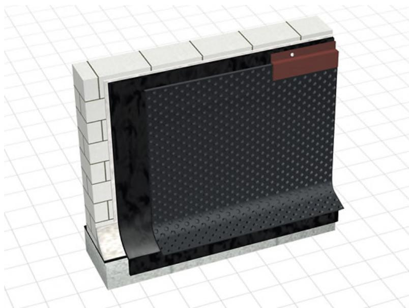
**Description:** système de protection vertical pour étanchéité ou support incompressible.
