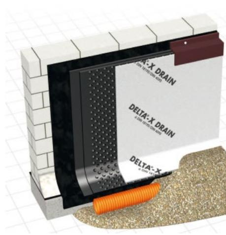
**Description:** système de drainage et de protection vertical pour étanchéité (type pâte bitumineuse) ou support compressible.
