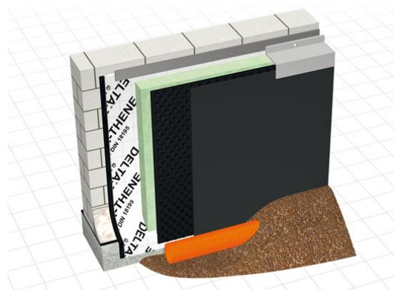
**Description:** système de drainage et de protection vertical pour étanchéité ou support incompressible.
