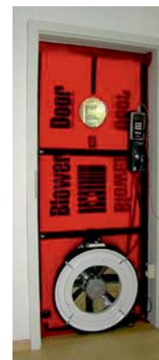
3. kép. Blower Door mérés
