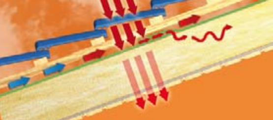
Bei konventionellen Bahnen dringt Hitze unters Dach.
